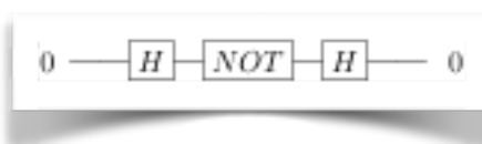
Figura 2b Circuito quantistico che esegue una computazione equivalente all'esperimento del fotone e del beam splitter.
